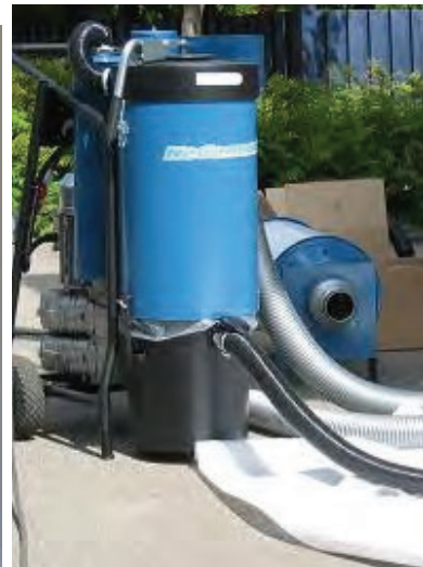
En centralsugare kan med fördel placeras utomhus
