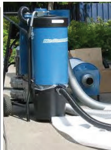
En centralsugare kan med fördel placeras utomhus
