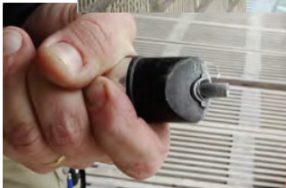
Monteringsverktyget är utformat för att möjliggöra korrekt insänkning
