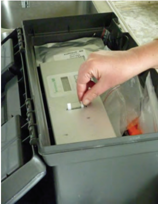
Testutrustning som mäter mängden asbestfibrer
