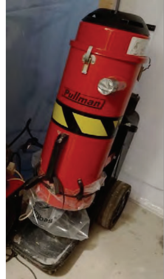
Dammsugare anpassad för asbest
