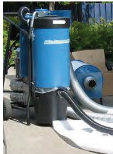
En centralsugare kan med fördel placeras utomhus
